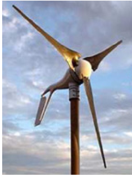
Σχήμα 7.1 - Ο προσανατολισμός προς την διεύθυνση του ανέμου με τη βοήθεια της «ουράς».
