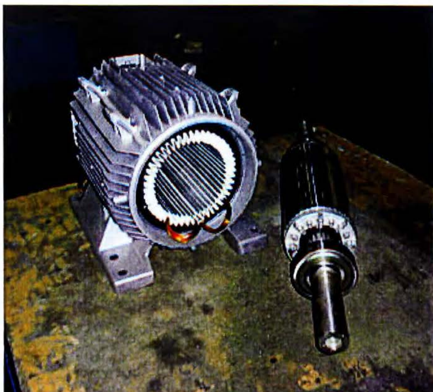
Εσωτερικό ασύγχρονου κινητήρα στην οποία διακρίνονται όλα τα δομικά του στοιχεία.
