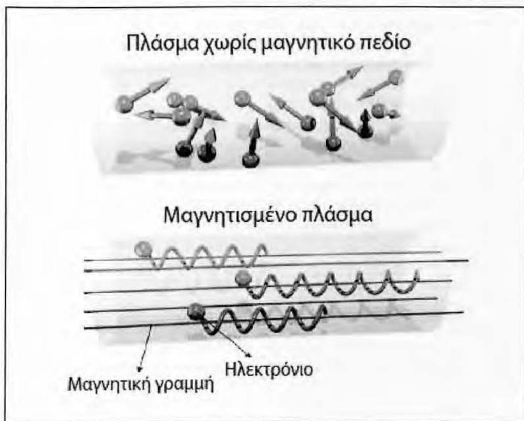
Σχήμα 1.4.1: Σχηματική αναπαράσταση των κινήσεων των ηλεκτρικών φορτίων του πλάσματος σε μαγνητισμένο και αμαγνήτιστο πλάσμα.
