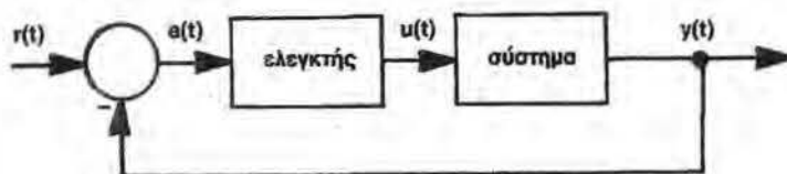
Έλεγχος συστήματος με ελεγκτή σειράς
