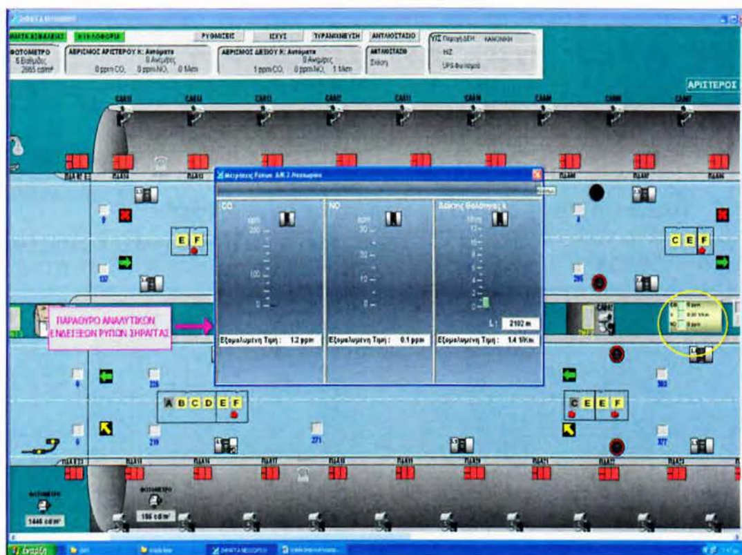
7.24: Μετρήσεις Ρύπων Δεξιού κλάδου σήραγγας
