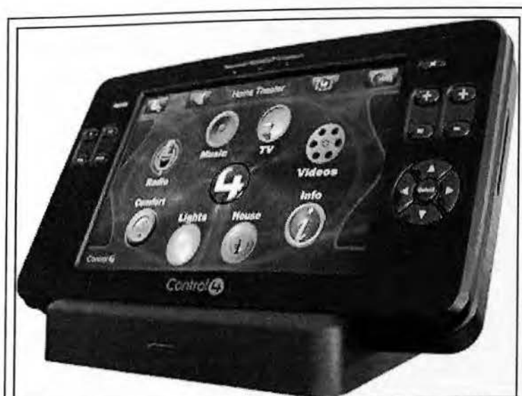
Εικόνα 1.91: Οθόνη αφής για ένα σύστημα οικιακού κινηματογράφου.
