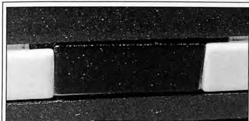
Εικόνα 1.74: Θύρα υπερύθρων πάνω σε στο κινητό τηλέφωνο CXT70 της εταιρίας Siemens.
