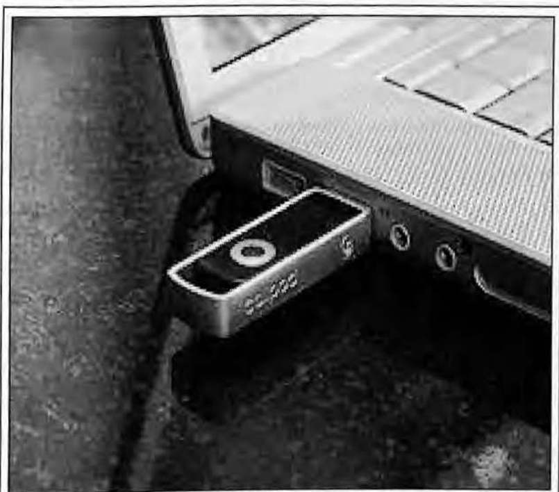
Εικόνα 1.75: Ένα Bluetooth dongle προσαρμοσμένο σε ένα φορητό υπολογιστή με δυνατότητα εμβέλειας 100 μέτρων.
