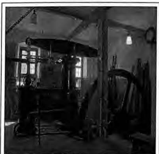
Εικόνα 1.23: Πιστό αντίγραφο της μηχανής Newcomen από τους Watt και Boulton κατασκευασμένη στο Freiberg της Γερμανίας το 1848.
