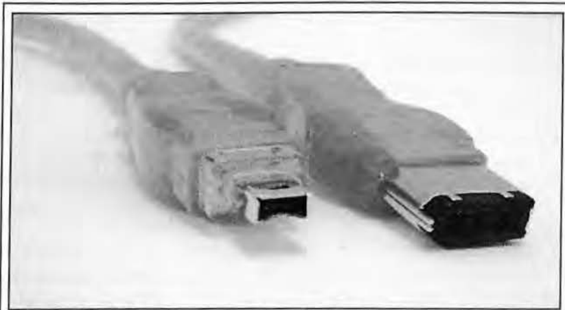
Εικόνα 1.73: 4 – pin και 6 – pin καλώδιο Firewire με δυνατότητα μεταφοράς 50 έως 400 MB/sec.
