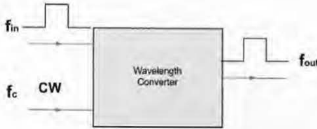
Εικόνα14 :Γενική αρχή λειτουργίας Μετατροπέα Μήκους Κύματος
