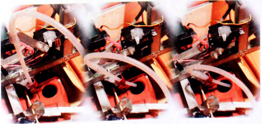
Εικ. 54 Κίνηση τοποθέτησης σωλήνα στο δοχείο του οχήματος
