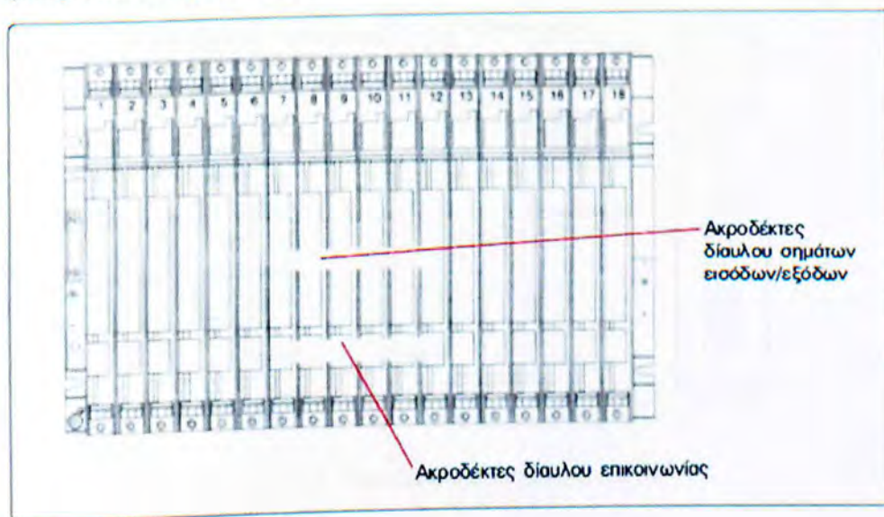
Εικόνα 3.12 : Πλαίσιο στήριξης PLC
