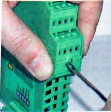
Εικόνα 5.20 Αριστερά Άνοιγμα καλύμματος – Δεξιά εντοπισμός jumper
