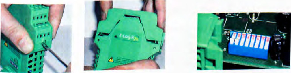
Εικόνα 5.18: Αριστερά Αφαίρεση καλύμματος- Δεξιά διακόπτες επιλογής διεύθυνσης
