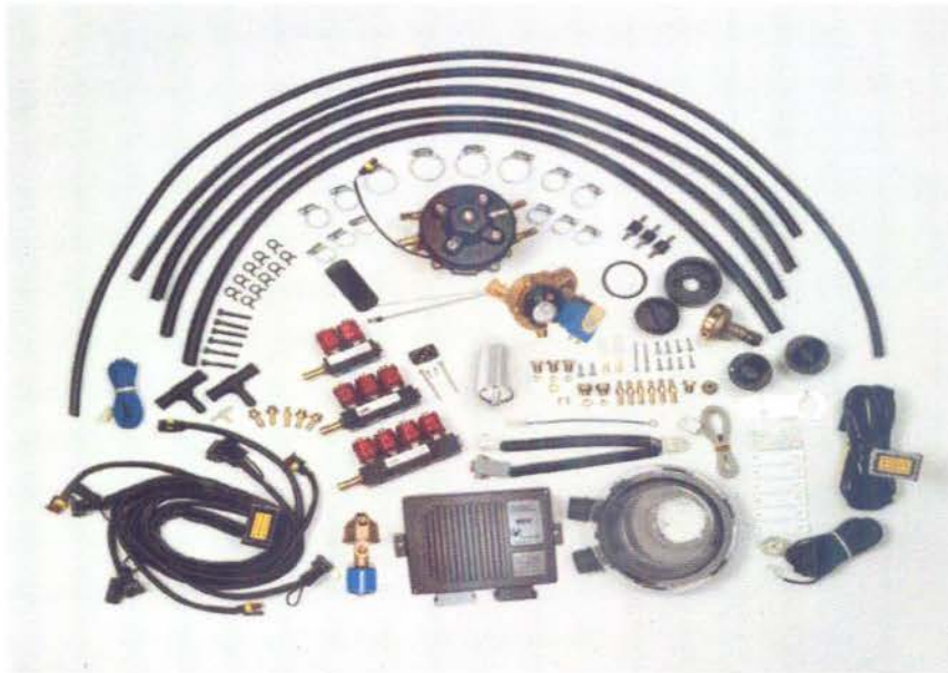
Εικόνα 2 . Εξαρτήματα συστήματος τέταρτης γενιάς
