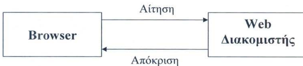
Σχήμα 1: Η σχέση πελάτη/διακομιστή μεταξύ ενός Web browser και ενός Web διακομιστή απαιτεί επικοινωνία.
