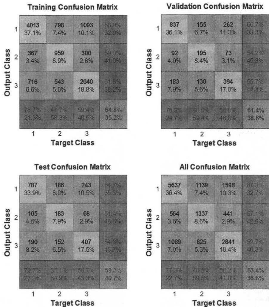
Εικόνα 57. Πίνακες Συγχύσεως για την εκπαίδευση, επικύρωση και την δοκιμή των ακολουθιών
