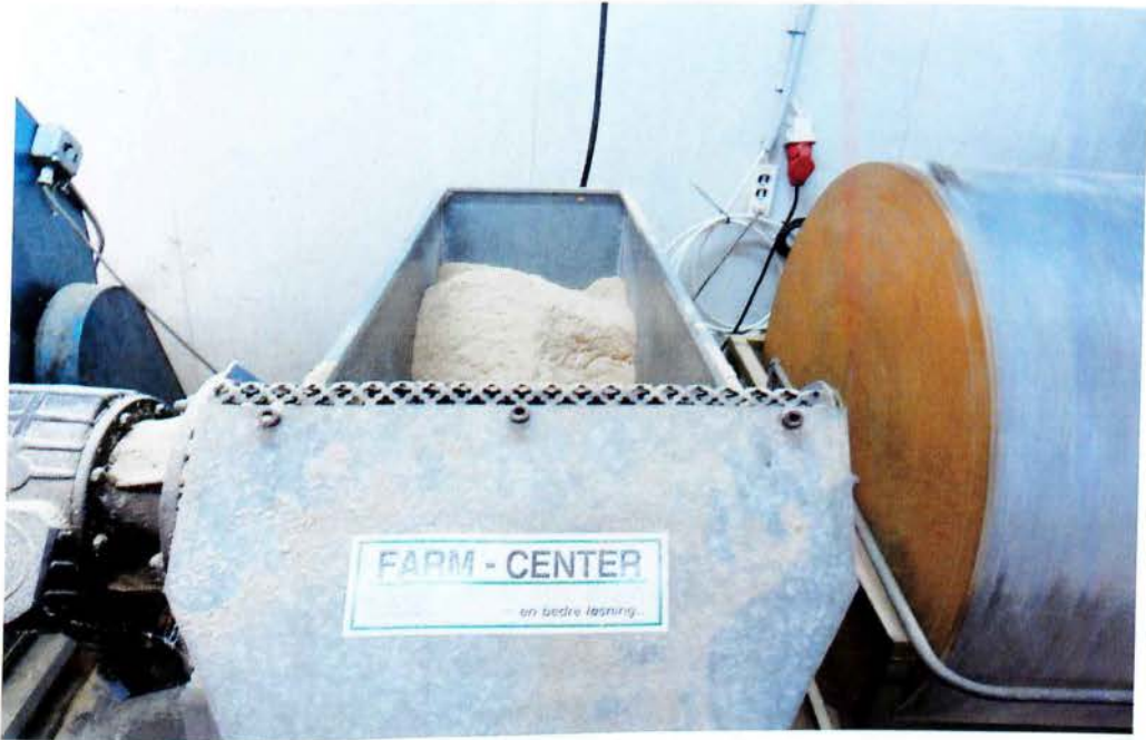
3.1.14 Κάδος που τοποθετείται το πριονίδι.
