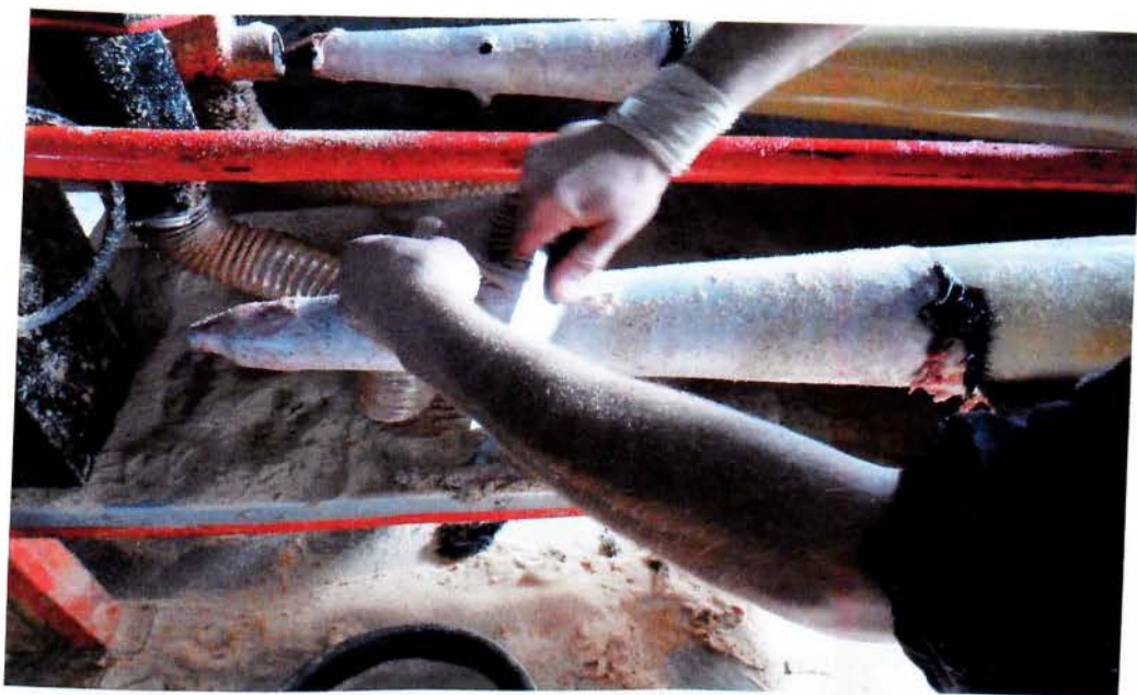
3.1.12 Λείανση του εσωτερικού του δέρματος με μαχαίρια.
