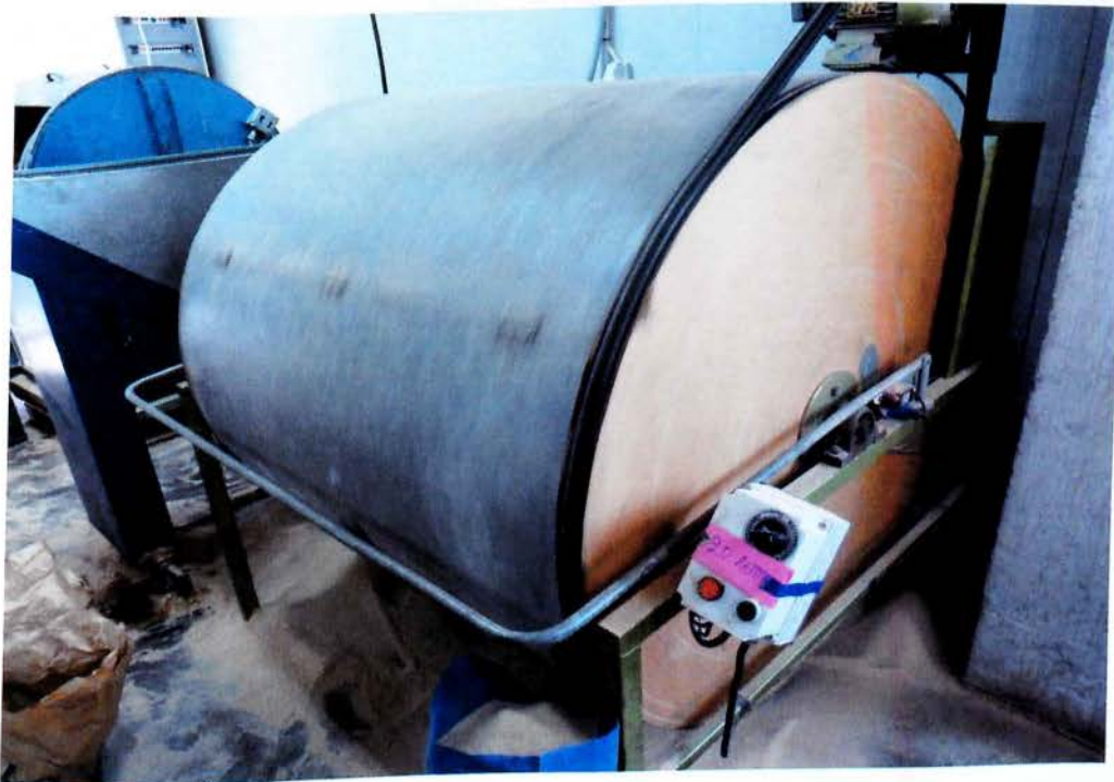
3.1.15 Περιστρεφόμενος θερμαινόμενος κύλινδρος.
