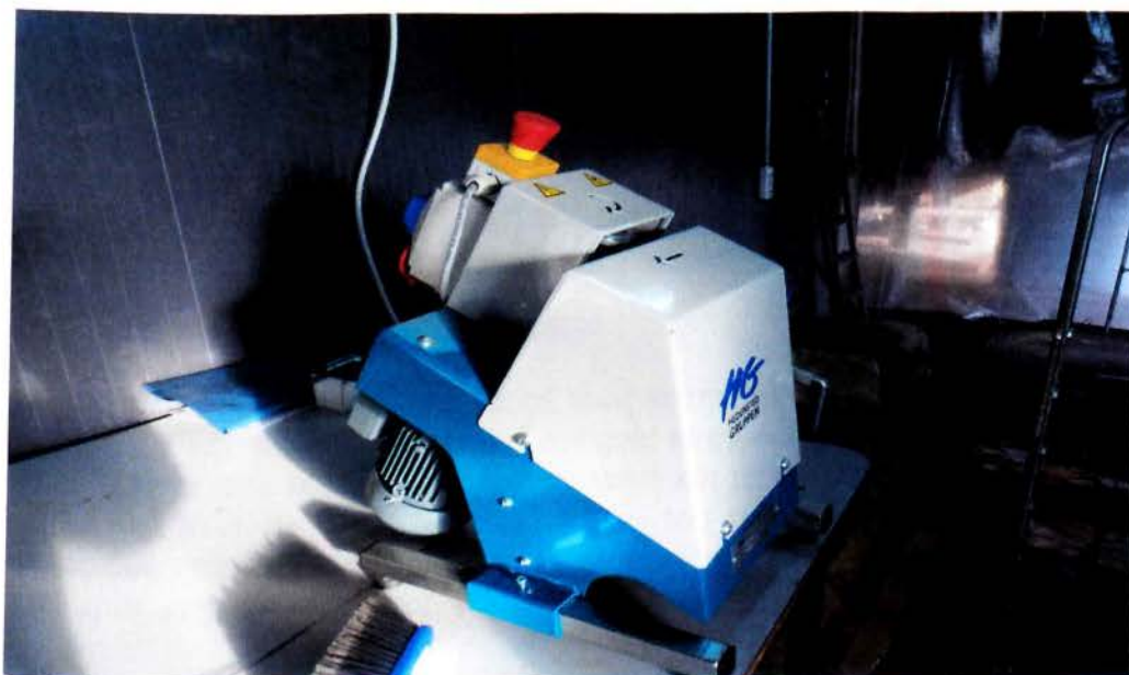
3.1.24 Μηχάνημα που λειαίνει και αφαιρεί τα υπολείμματα από πριονίδι
