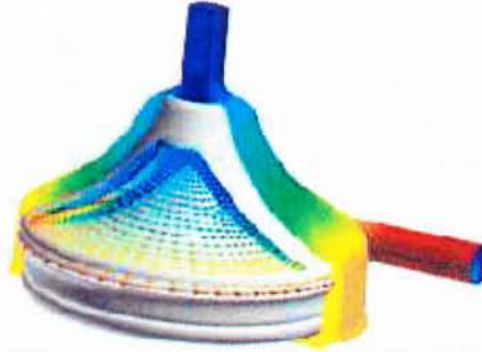
Εικόνα 1.5: Κατανομή πίεσης σε βαλβίδα καρδιάς.
