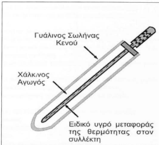
Σχήμα 2.10: Τομή Σωλήνα Συλλέκτη Κενού
