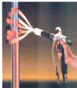
Σχήμα 2.2.1.7-1: Διαγραμματική απεικόνιση ψεκαστήρα ηλεκτροστατικής βαφής
