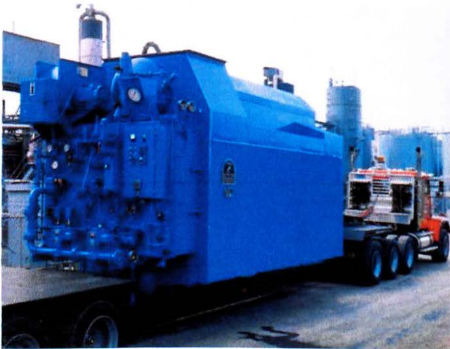
Εικόνα 3.4.1 Μονάδα παραγωγής ζεστού νερού
