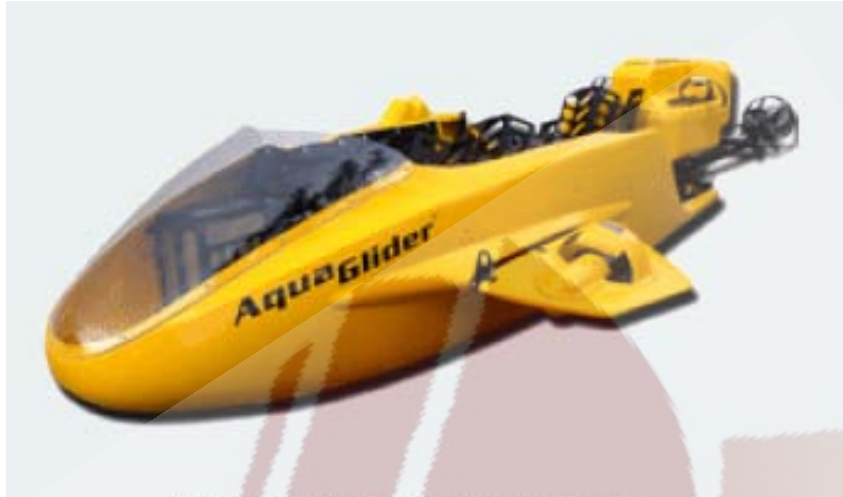
Αquaglider – Υποβρύχιο Σκάφος από Fiberglass της Εταιρίας Fiberglass Sales, Inc.
