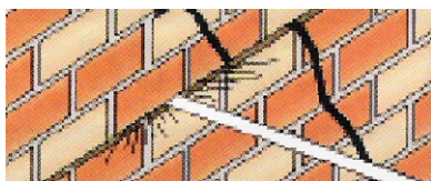
Εικόνα [53] καθάρισμα του αρμού με πεπιεσμένο αέρα ή νερό
