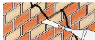
Εικόνα [54] Έγχυση πρώτης στρώσης κονιάματος
