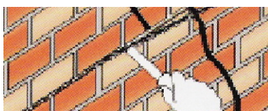
Εικόνα [55] Εισαγωγή ράβδου με βοήθεια καλεμιού
