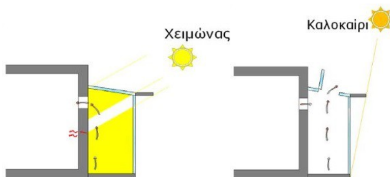
Χειμερινή και θερινή λειτουργία θερμοκηπίου, με ανοιγόμενα υαλοστάσια
