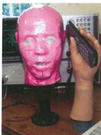
Σχ.6 . Ομοίωμα ανθρώπινης κεφαλής για μετρήσεις απορροφώμενης ισχύος
