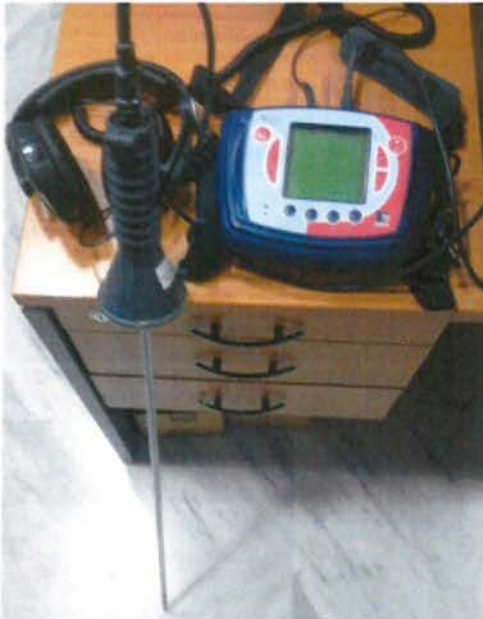
Το όργανο Xmic με τοποθετημένο το αισθητήριο για ανίχνευση απομόνωσης βανών
