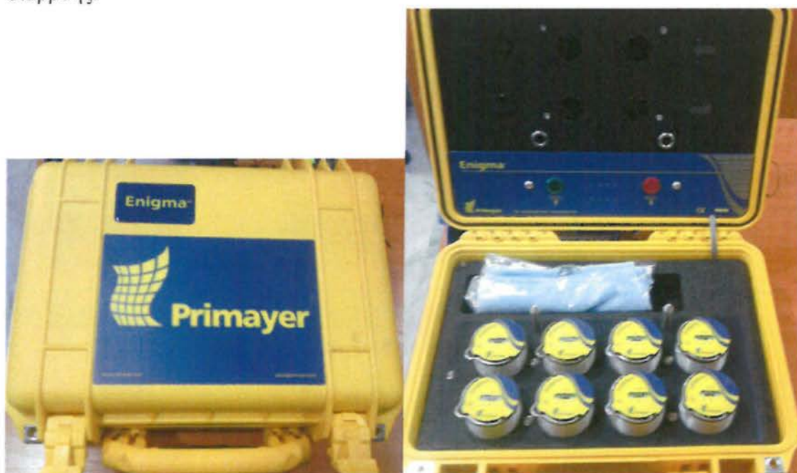
ειδική βαλίτσα τοποθέτησης και επεξεργασίας των καταγραφικών θορύβου (Enigma)
