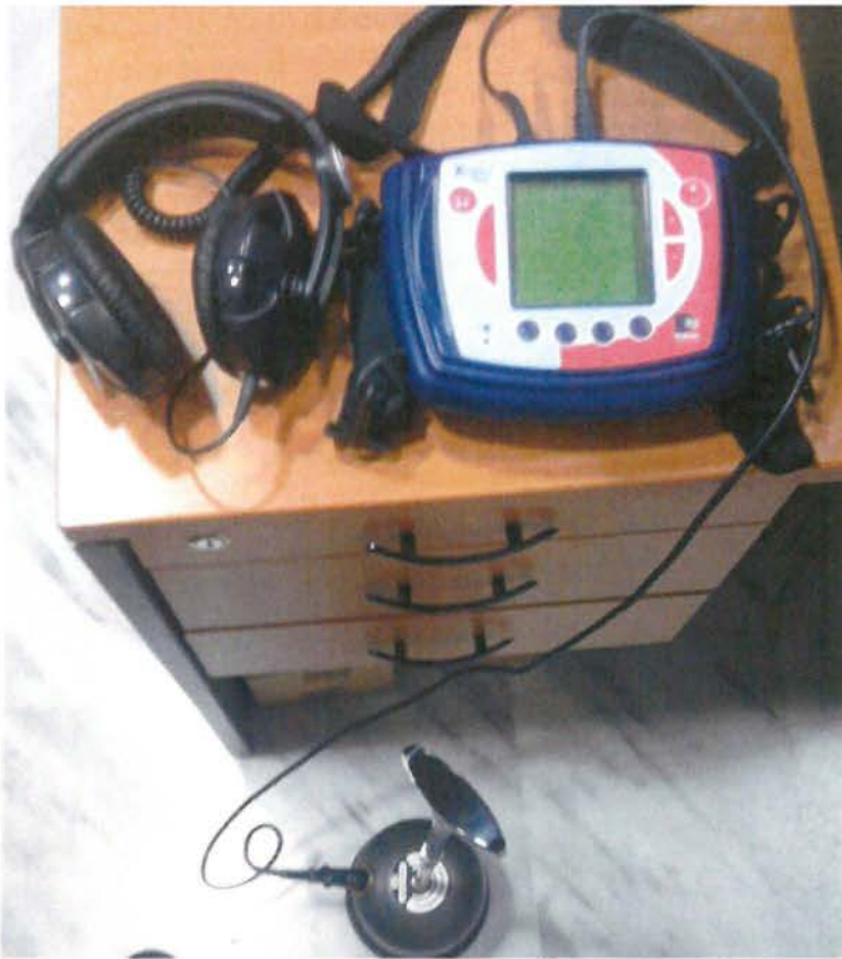
Τοποθετημένο το αισθητήριο ανίχνευσης διαρροής αγωγών Xmic
