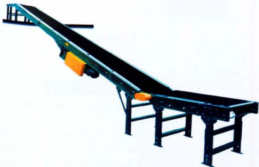
Εικόνα 25 Σημαντικός παράγοντας στην τελική μορφή του συστήματος μεταφορικών ταινιών είναι το ανάγλυφο του εδάφους στην περιοχή των εγκαταστάσεων (Δ. Βασιβαλής, Δ. Γενικός Εξοπλισμός - Ταινιόδρομοι Μεταφοράς Προϊόντων. www.texnika-inox.gr )
