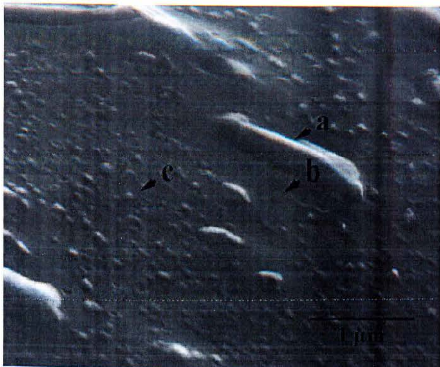
Εικόνα 3 (Μικροκλίμακα (a) νανοκλίμακα (c) στο όριο μιας όψης κόκκου σε δείγμα έχοντας υποβληθεί σε θερμική επεξεργασία T6b μετά από ψαθυροποίηση υδρογόνου, (b) για τα σημεία των ιζημάτων που βρίσκονται στην ελεύθερη ζώνη).
