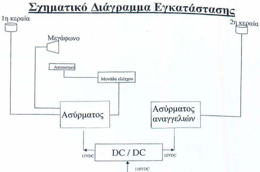
εικόνα 17. Σχηματικό διάγραμμα εγκατάστασης ασυρμάτου
