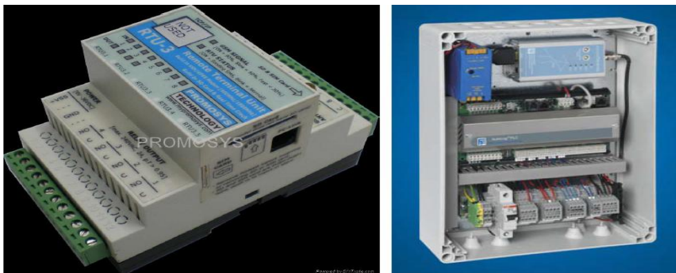
Σχήμα 1.3: Εσωτερική εγκατάσταση RTU
