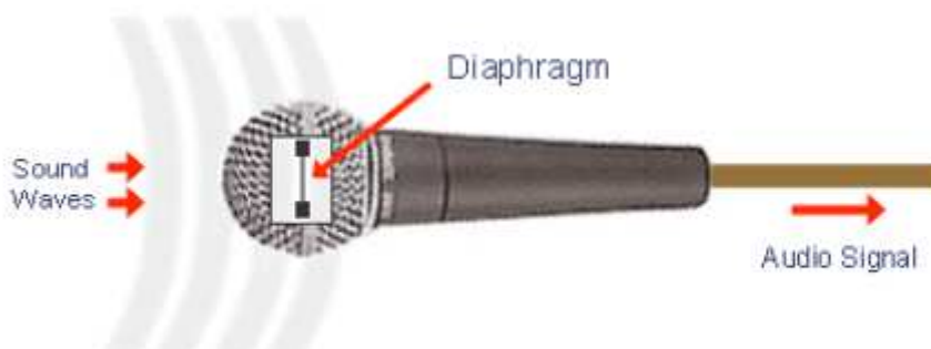
Εικόνα: Αναπαράσταση του εσωτερικού ενός μικροφώνου
