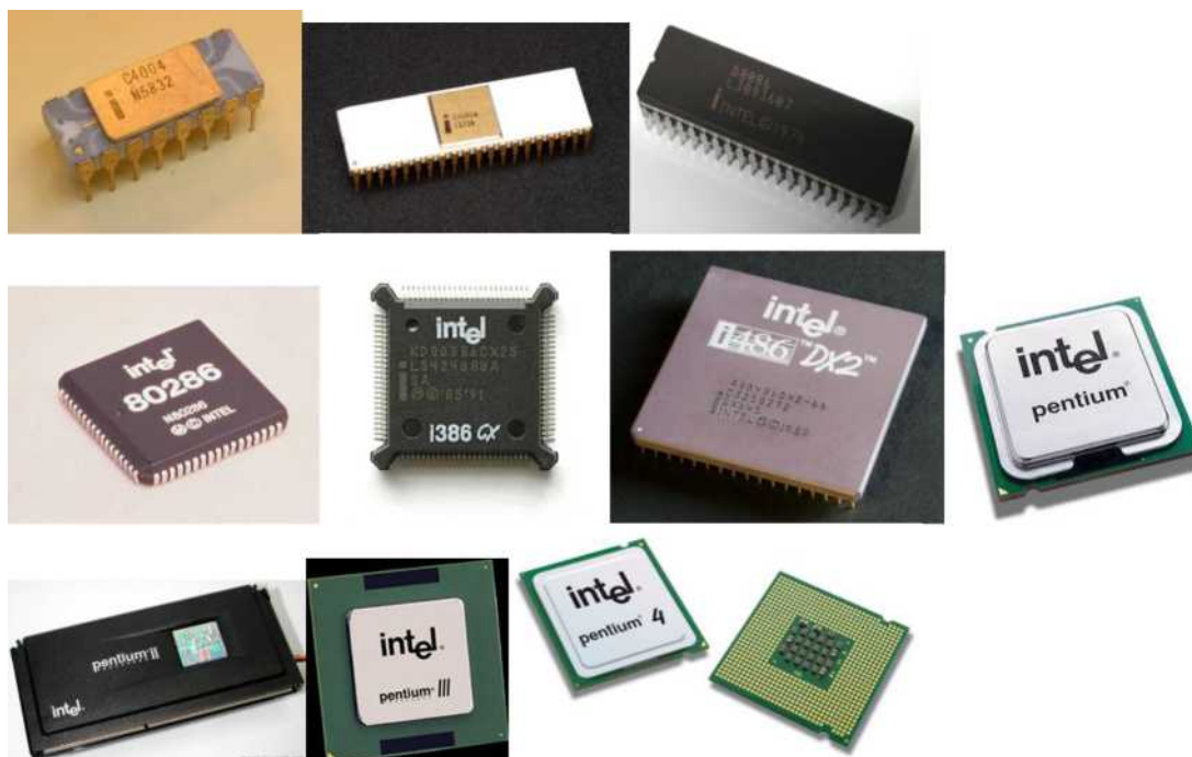
Εικόνα 1.1: Intel 4004, 8080, 8086/8088, 80286, 80386, 80486, Pentium, II, III, IV
