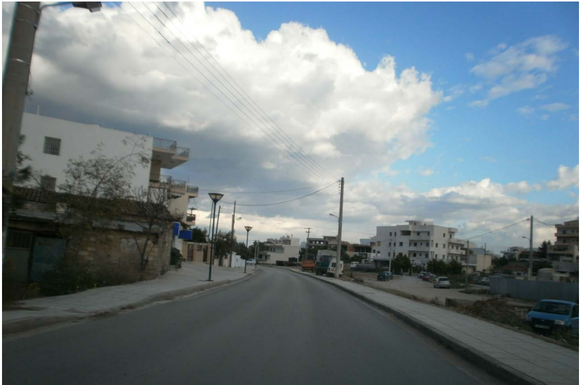
Εικόνα 109 Μεγάλα πεζοδρόμια με ράμπες και φωτιστικά. Οι στύλοι της ΔΕΗ βρίσκονται πίσω από τα πεζοδρόμια, τα οποία δεν είναι γεμάτα με δέντρα κτλ. Είναι περιφερειακός δρόμος, διπλή κατεύθυνσης. Οδός Σπ. Καραγιώργου.
