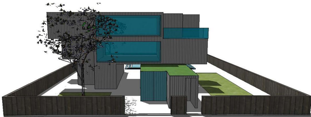
Εικόνα 32 Η βορινή πλευρά του κτιρίου είναι συγχρόνως και η πρόσοψη του. Για λόγους καλαισθησίας προτιμήθηκαν μεγάλα ανοίγματα με πρόβλεψη προστασίας από φυλλοβόλα δέντρα.
