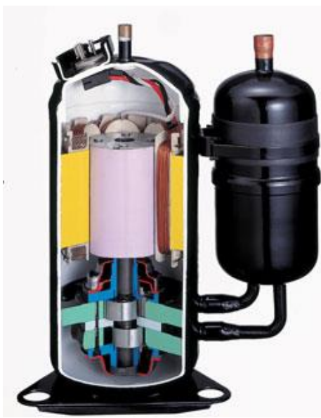
Εικόνα1.9: Περιστροφικός συμπιεστής κλειστού τύπου σε τομή
