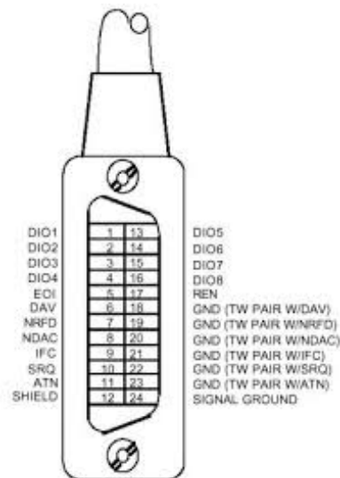
Εικόνα 1.12: GPIB Pins
