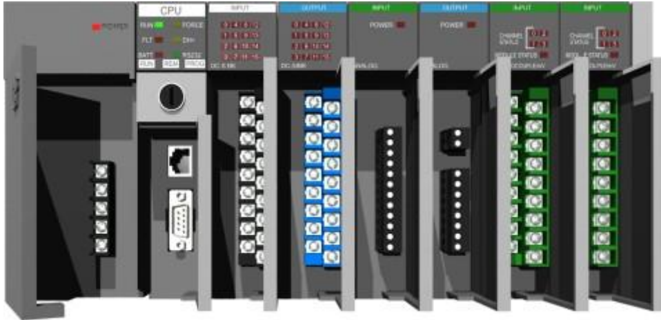
Εικόνα 36 Πρόσοψη PLC με ανοιχτές τις θύρες [20]
