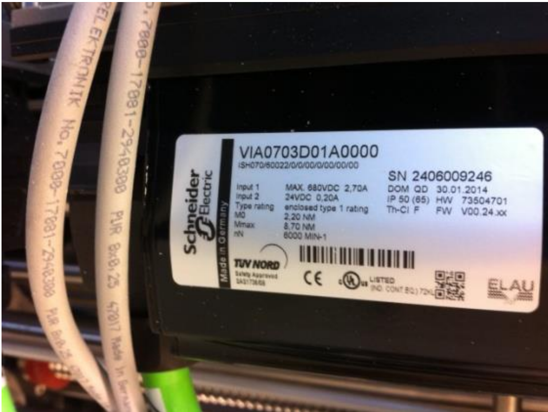
Εικόνα 24Νεα τεχνολογία Καπακοτικών (8 κεφαλές): Καθεκεφαλή δικό της βηματικό κινητήρα για καλύτερο έλεγχο
