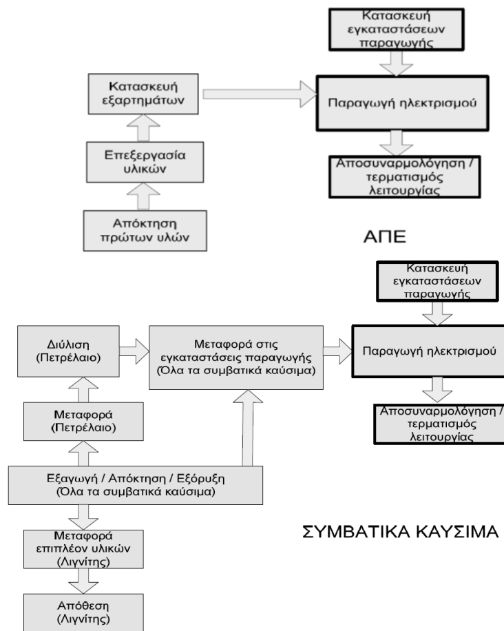
Εικόνα 4.3-1 :Όρια συστήματος που περιλαμβάνονται στην ανάλυση κύκλου ζωής σε συστήματα παραγωγής ηλεκτρικής ενέργειας με ΑΠΕ και με συμβατικά καύσιμα
