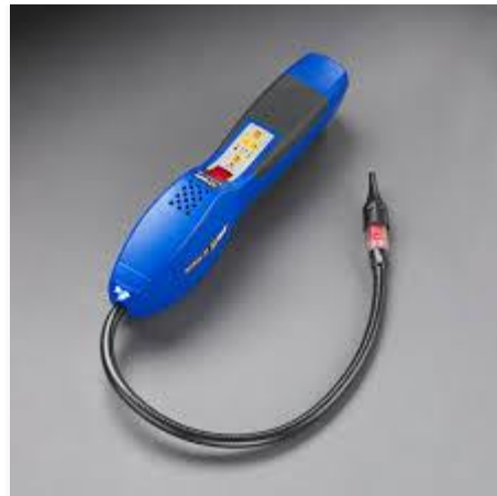
Σχήμα 6.3- Λυχνία εντοπισμού διαρροών φρέον
