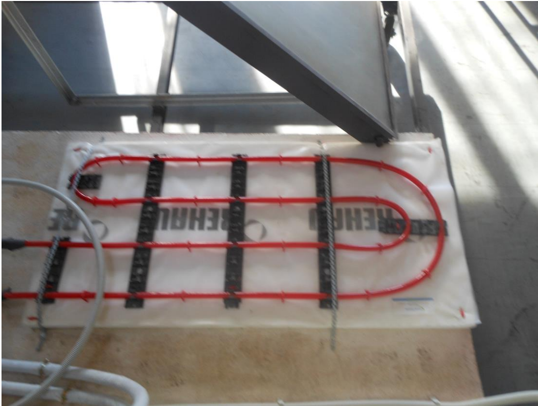
Σχήμα 5.2- Ενδοδαπέδια θέρμανση εργαστηριακής κατασκευής
