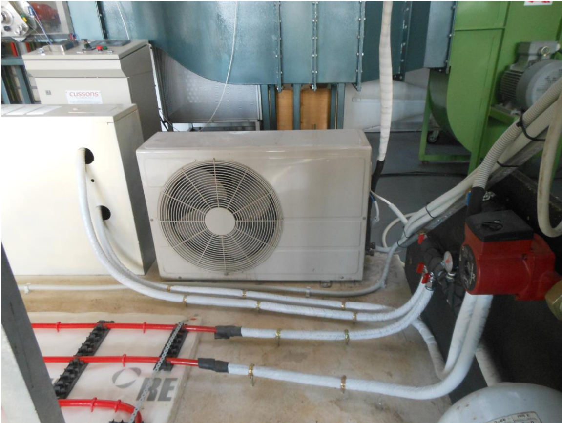
Σχήμα 2.2- Αντλία θερμότητας πειραματικής διάταξης
