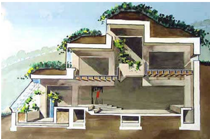
Εικόνα 11. Κέλυφος κτιρίου για περιορισμό της θερμικής απώλειας
