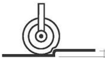
Εικόνα 8. Τα κατώφλια των θυρών που οδηγούν στον ανελκυστήρα. [8]
