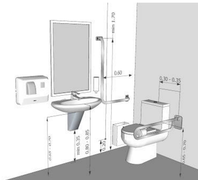
Εικόνα 20. Προοπτικό χώρου υγιεινής Τύπου Β. [10]
