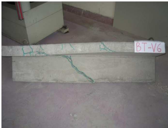
Εικόνα 13. Μορφή Αστοχίας ΒΤ - V6 (Πλάγια Όψη Πλακοδοκού)
