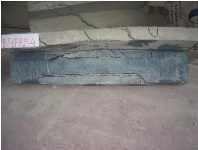
Εικόνα 15. Μορφή Αστοχίας (Πλάγια Όψη Πλακοδοκού)
