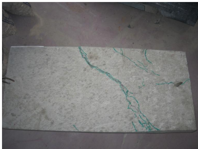
Εικόνα 14. Μορφή Αστοχίας ΒΤ - V6 (Κάτοψη Πλακοδοκού)
