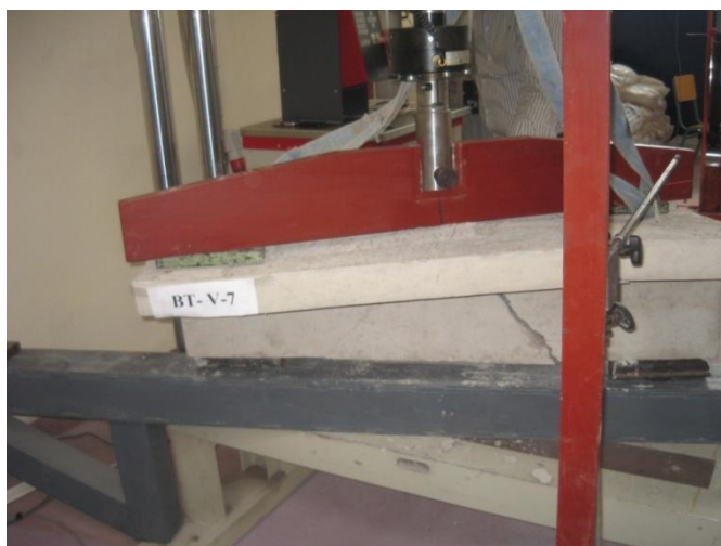
Εικόνα 17. Μορφή Αστοχίας ( Πλάγια Όψη Πλακοδοκού)
