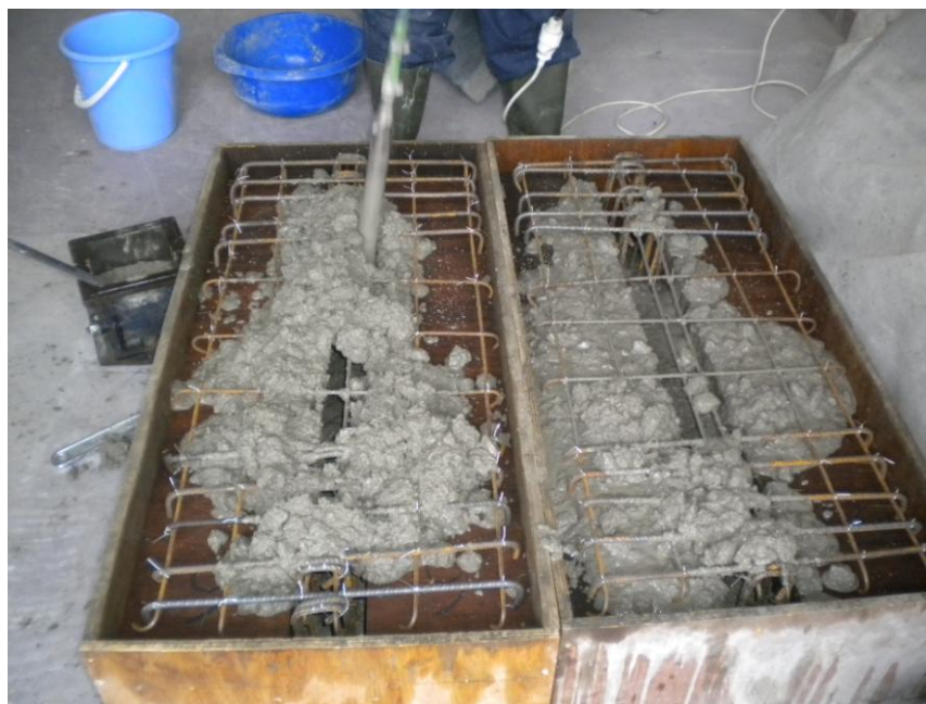
Εικόνα 7. Σκυροδέτηση δοκιμίων με χρήση δονητή
