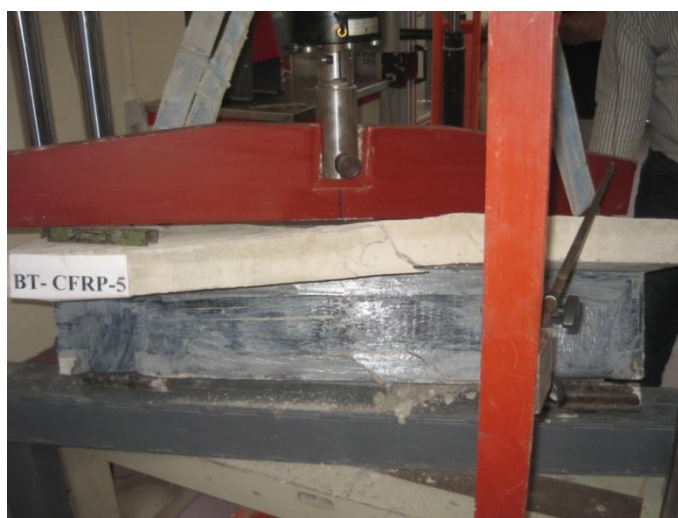
Εικόνα 18. Μορφή Αστοχίας ( Πλάγια Όψη Πλακοδοκού)
