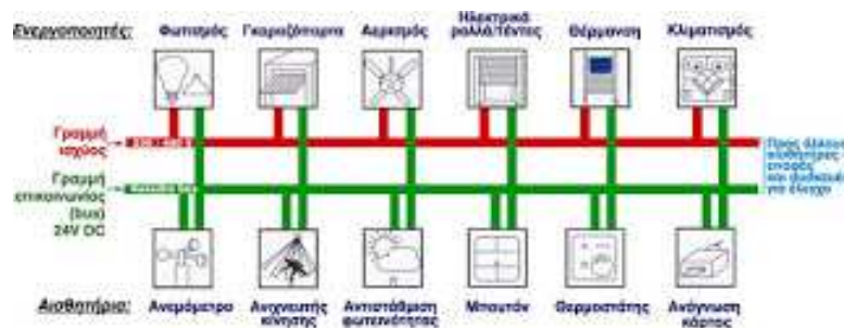
Εικόνα 1.8: Σύστημα Bus με αρχιτεκτονική της KNX
