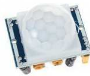
Εικόνα 2.12: Αισθητήρας Παθητικών Υπερύθρων (PIR)
