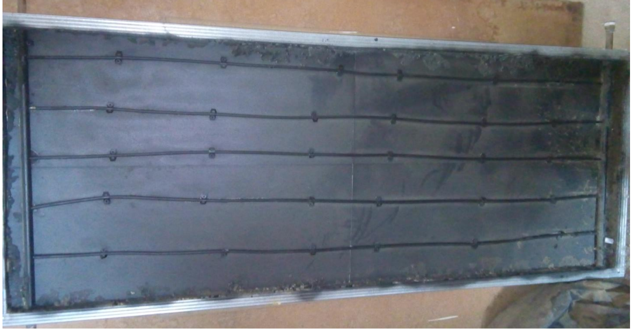
Σχήμα 10.3 και 10.4 στάδιο βαψίματος των ηλιακών πάνελ με μαύρο ματ χρώμα
