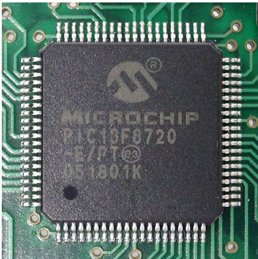
Σχήμα 8.2 PIC18F8720 της MICROCHIP
