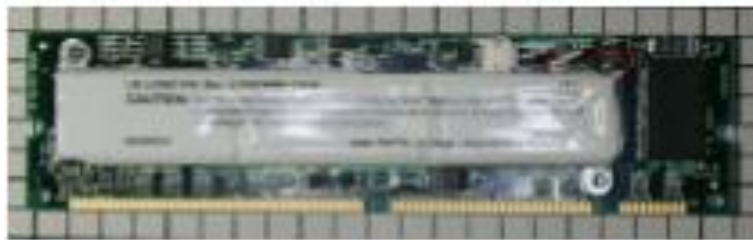
Σχήμα 7.3 (Εικόνα 3): Μνήμη DRAM με ενσωματωμένη μπαταρία.
