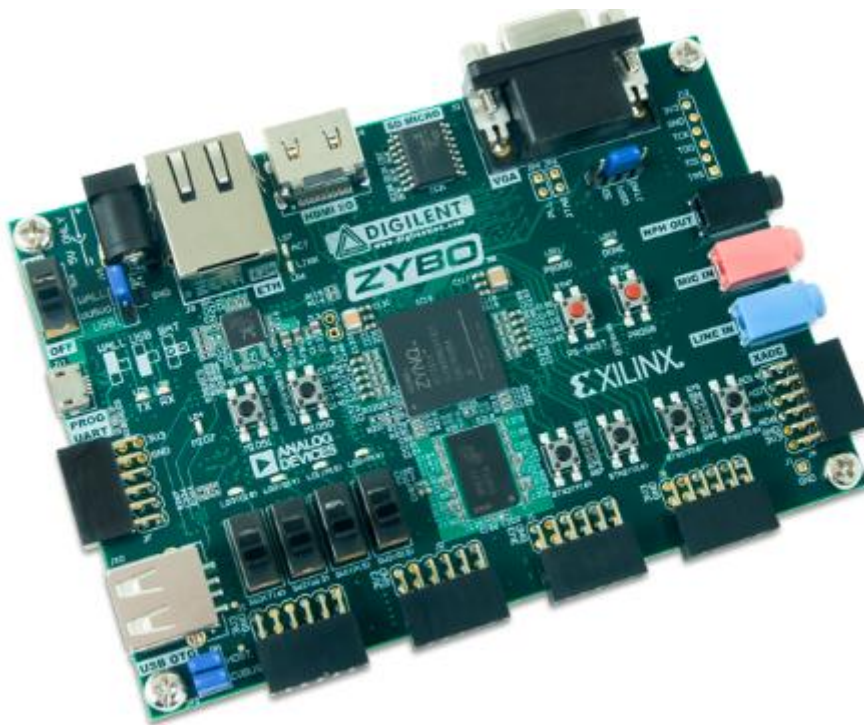
Σχήμα 7.11 (Εικόνα 3) : Στα ενσωματωμένα συστήματα μπορεί να χρησιμοποιηθεί κάποια αρχιτεκτονική FPGA που εμπεριέχει και έναν ή περισσότερους επεξεργαστές.
