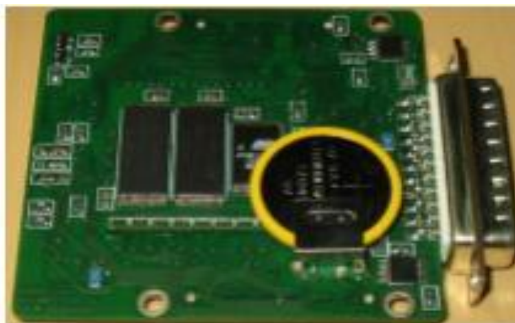
Σχήμα 7.3 (Εικόνα 2): Ένα ΕΣ (Gecko100) που φέρει μνήμη RAM με υποστήριξη τροφοδότησης από μπαταρία.
