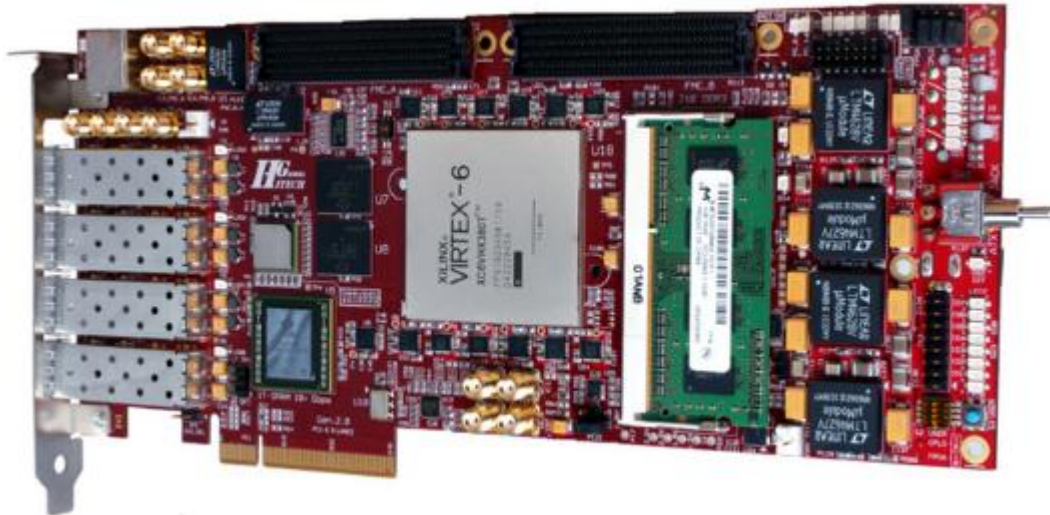
Σχήμα 7.11 (Εικόνα 2): Ο επιταχυντής σε ένα Ενσωματωμένο σύστημα, μπορεί να είναι μια κάρτα FPGA που συνδέεται στο διάλυλο του συστήματος. Εδώ φαίνεται η Virtex 6 FPGA κάρτα της Xilinx με διεπαφή PCI Express.
