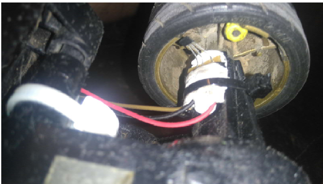
Εικόνα 23: Αισθητήρας HALL πίσω τροχού
