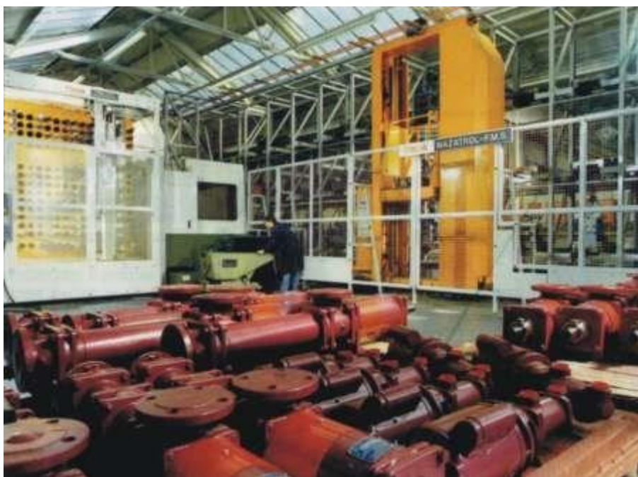
Σχήμα 2.7. Εδώ βλέπουμε μια παρτίδα από αντλίες νερού οι οποίες περιμένουν τη σειρά τους να φορτωθούν στο κέντρο κατεργασίας, για να ολοκληρωθεί η παραγωγή τους. Με άλλα λόγια τα προς κατεργασία τεμάχια βρίσκονται σε κατάσταση «αδράνειας». (Courtesy of Yamazaki Machinery UK Ltd., Worcester, UK).
