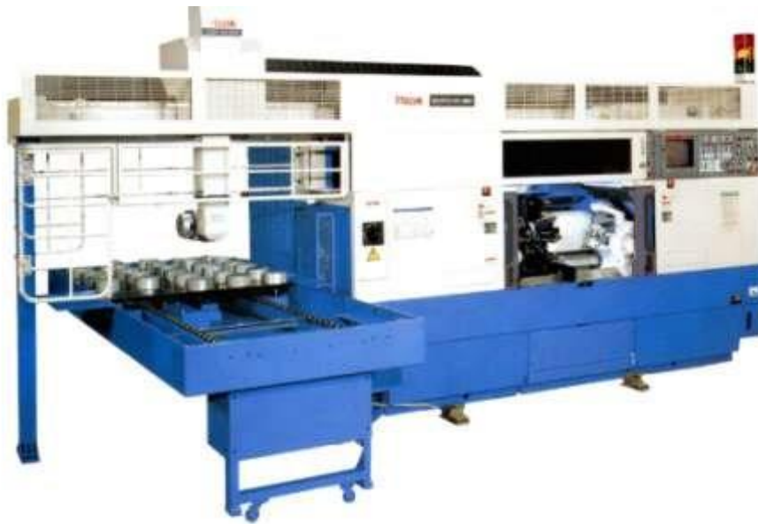
Σχήμα 2.4. Ένα κέντρο τόνρευσης υψηλού ρυθμού παραγωγής σε λειτουργία. Το παραγωγικό αυτό σύστημα διαθέτει και αυτόματο σύστημα τροφοδοσίας των προς κατεργασία τεμαχίων. (Multiplex 320 Cell). (Courtesy of Yamazaki Machinery UK Ltd., Worcester, UK).
