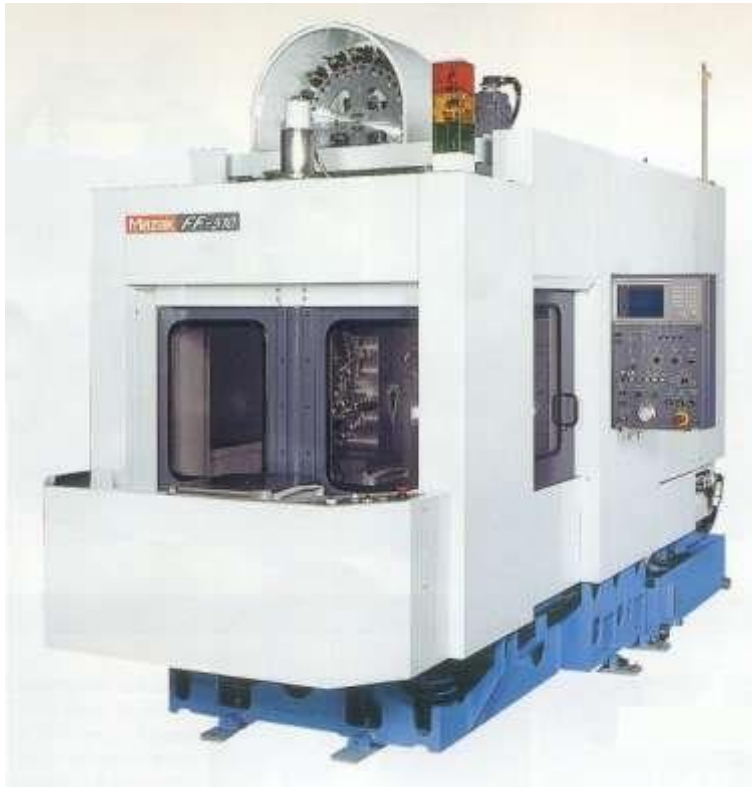
Σχήμα 2.8. Μία μηχανή, ένα οριζόντιο κέντρο κατεργασίας το οποίο μπορεί να πραγματοποιήσει κατεργασίες, όπως φρεζάρισμα, σπειροτόμηση, τρύπημα, κλπ. (Courtesy of Yamazaki Machinery UK Ltd., Worcester, UK).
