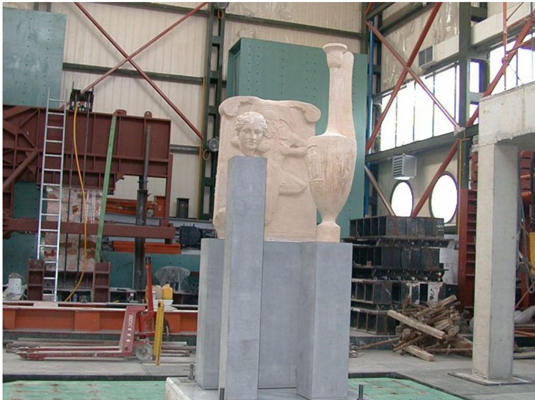
Σχ. 2.36 Διερεύνηση της σεισμικής συμπεριφοράς βάσης αρχαιολογικών εκθεμάτων. ( //lee.civil.ntua.gr )
