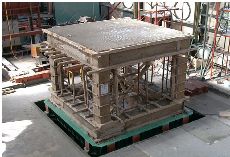
Σχ. 2.37 Σεισμική τράπεζα EMPI. ( http://lee.civil.ntua.gr )
