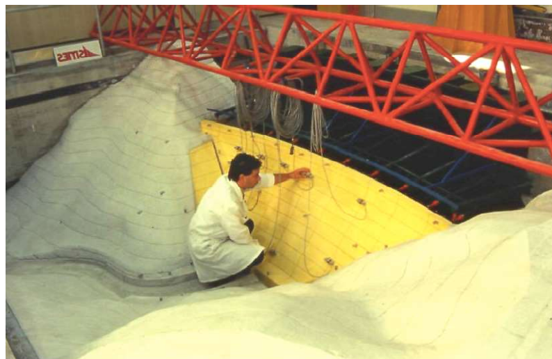
Σχ. 2.33 Ομοίωμα φράγματος. (Μπούσιας 2015)
