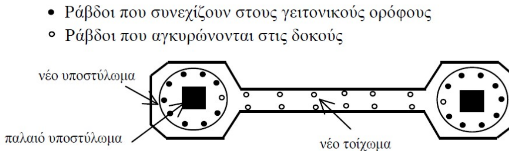
Σχ. 2.9 Ενδεικτική εμφάνωση με πάχος ίσο ή μικρότερο του πλάτους της δοκού. (ΚΑΝ.ΕΠΕ.)
