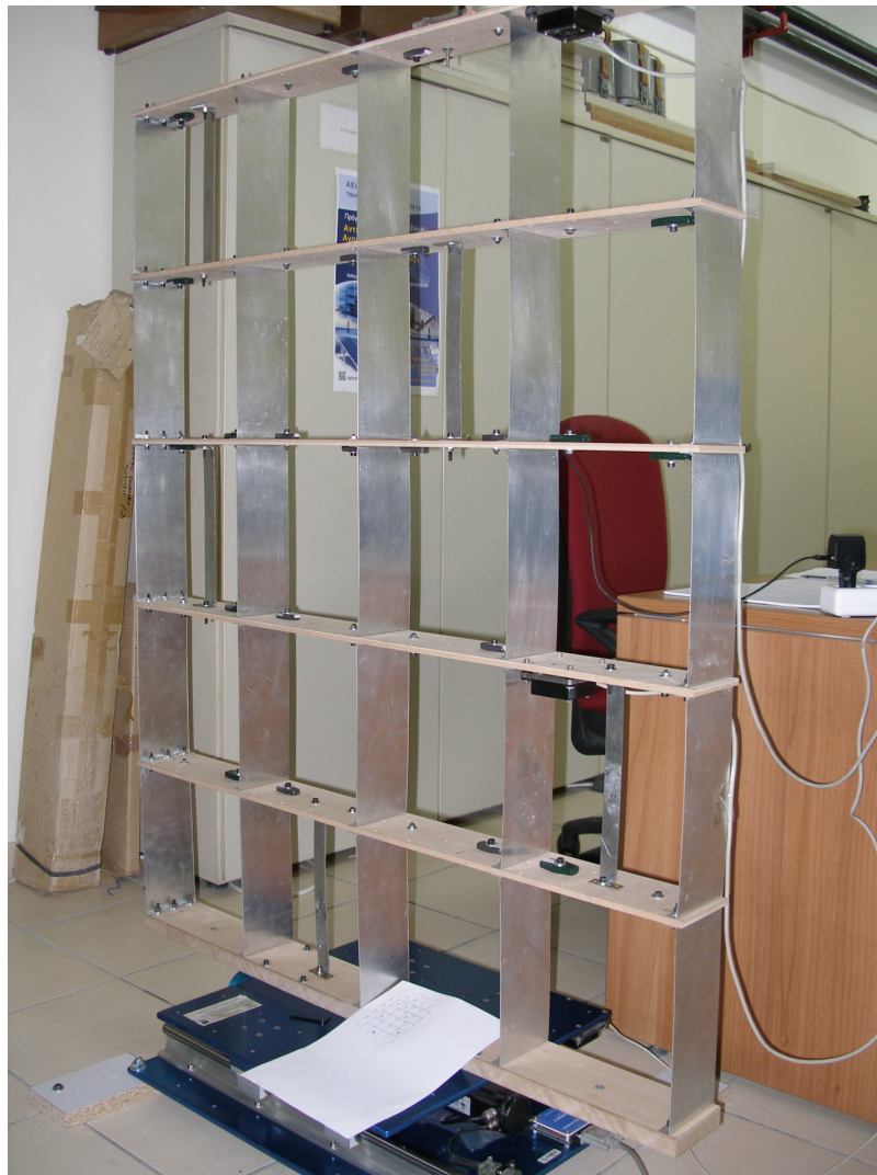
Σχ. 4.4 Προσομοίωμα κατασκευής στην σεισμική τράπεζα μικρής κλίμακας.
