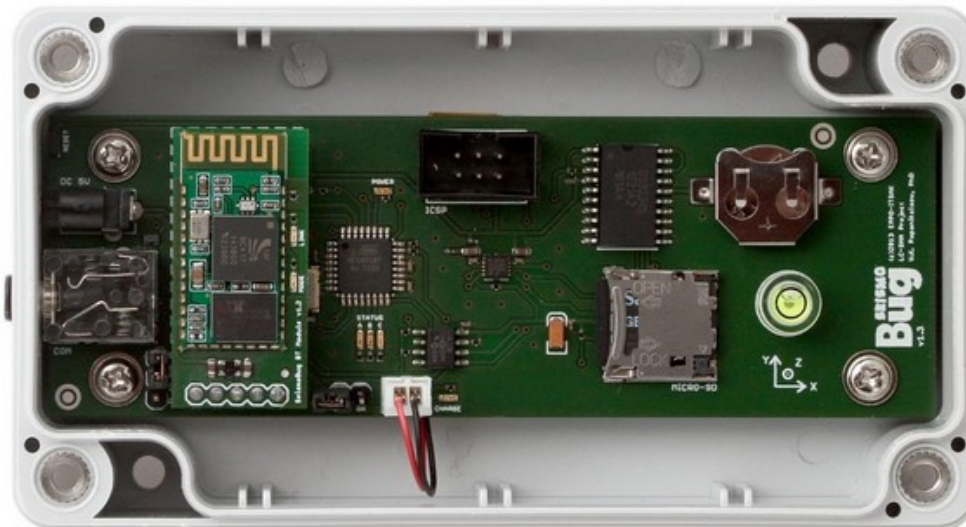
Σχ. 2.45 Επιταχυνσιογράφος SeismoBug. ( www.seismobug.com )
