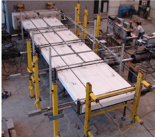
Σχ. 2.34 Πειραματικές δοκιμές εμφάντωσης τοιχωμάτων. (Στρεπέλιας 2012)
