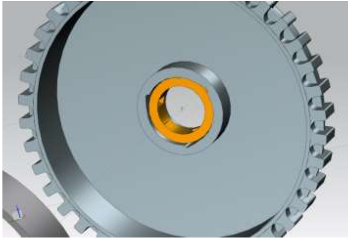
Εικόνα 4.4 μεγένθυση ανεπιστρεπτό ρουλεμάν εμπλοκής άξονα ποδηλάτου με δίσκο ιμάντα κίνησης
