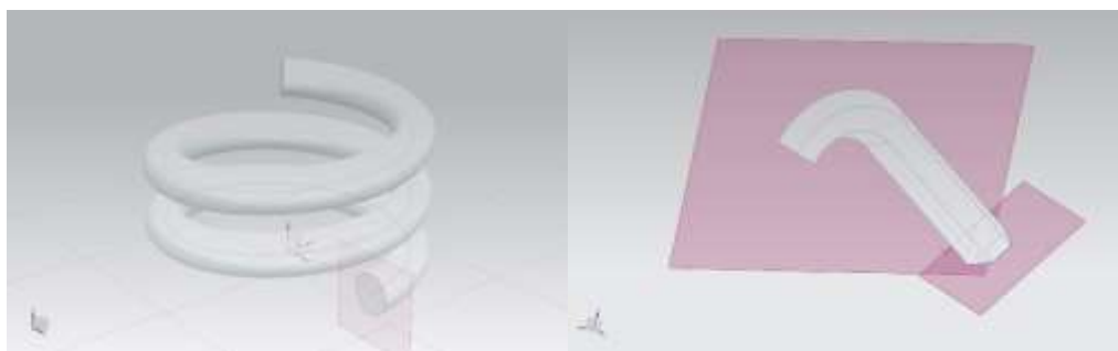
Εικόνα 3.3 Διάφοροι τύποι διαδρομής των επιπέδων τομής και σχήματα που δημιουργούνται
