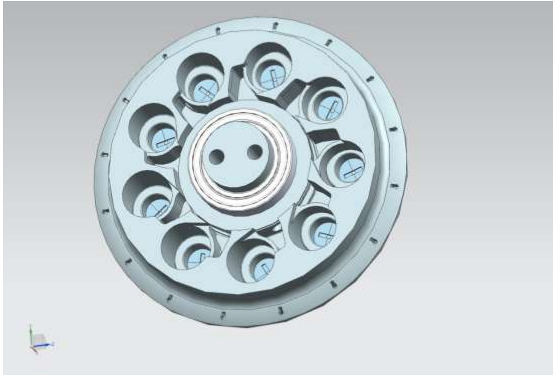
Εικόνα 4.7 εστίαση στην διαμόρφωση των αυλών για την μείωση του μήκους της αντλίας
