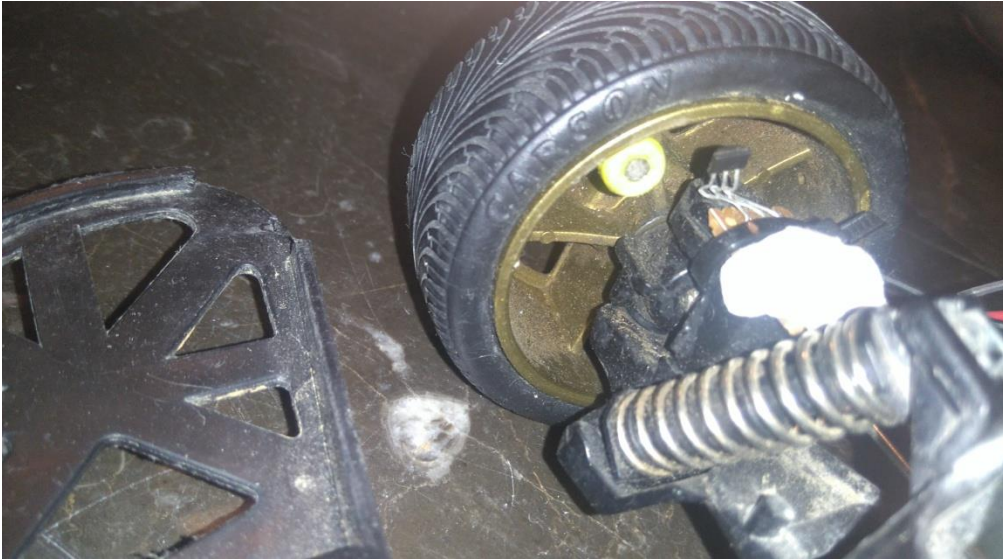
Εικόνα 3.3 Αισθητήρας HALL μπροστά τροχού
