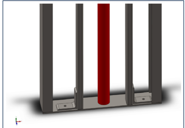
Εικόνα 90: Θέση τοποθέτησης του εμβόλου στην βάση των οδηγών.
