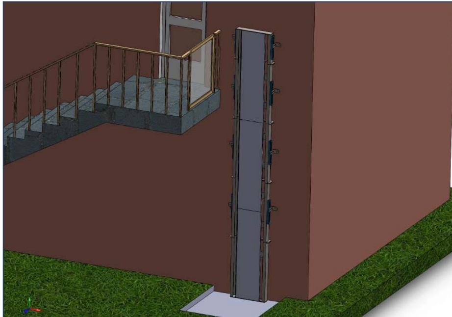
Εικόνα 13: Τοποθέτηση και συναρμολόγηση οδηγών με τα καλύμματα τους.
