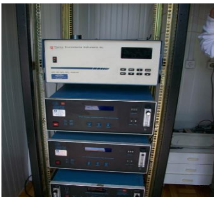
Εικόνα: Όργανα καταγραφής αερίων ρύπων στο Σταθμό Παρακολούθησης Αερίων Ρύπων του ΟΛΠ ΑΕ.
