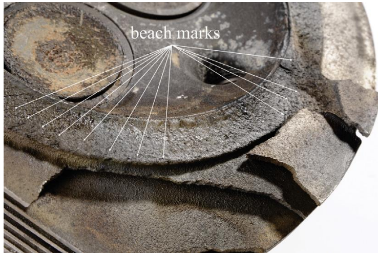
Σχ. 5.7: Σημάδια εξέλιξης σε κάταγμα κόπωσης (beach marks).
