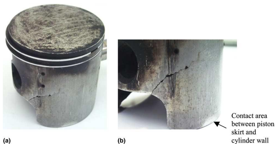
Σχ. 4.8: Κατεστραμμένο έμβολο με ρωγμή στο τελείωμα του: (a) έμβολο, και (b) σημείο επαφής με τον κύλινδρο.
