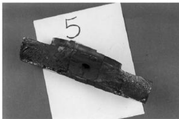
Σχ. 3.1.5 Μακροσκοπική όψη των κατεστραμμένων επιφανειών των στροφαλοφόρων αξόνων.
