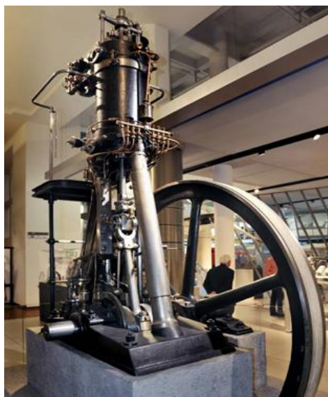
Σχ. 1.3: Πρώτη μηχανή Diesel με ικανοποιητική απόδοση (1897)
