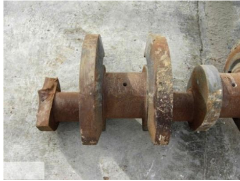
Σχ.3.1.9 Τελική αστοχία στροφαλοφόρου άξονα Νο 1
