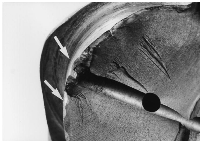
Σχ. 3.2.5 Η επιφάνεια θραύσης του στροφείου (αναντιστοιχία οπής διάνοιξης- οπής λαδιού).
