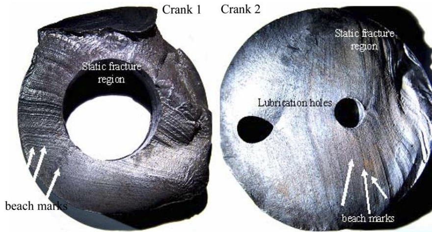
Σχ. 3.1.6 Επιφάνειες θραύσης στροφαλοφόρων αξόνων.
