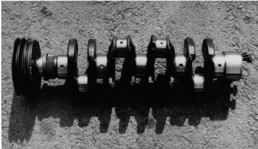
Σχ. 3.2.7: Αστοχία στροφαλοφόρου άξονα.
