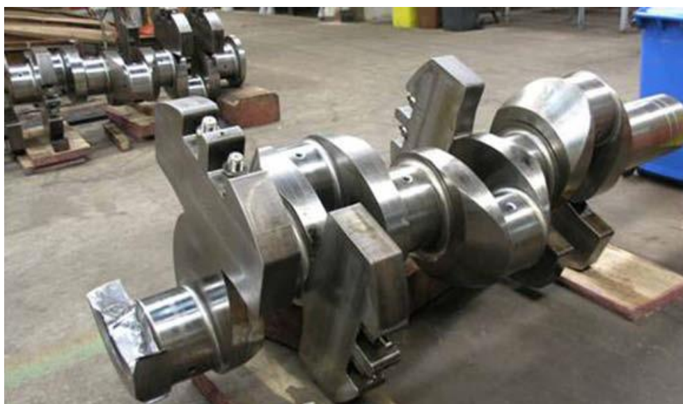
Σχ. 3.1.14 Αστοχία στο 4 ο κομβίο του στροφαλοφόρου άξονα.
