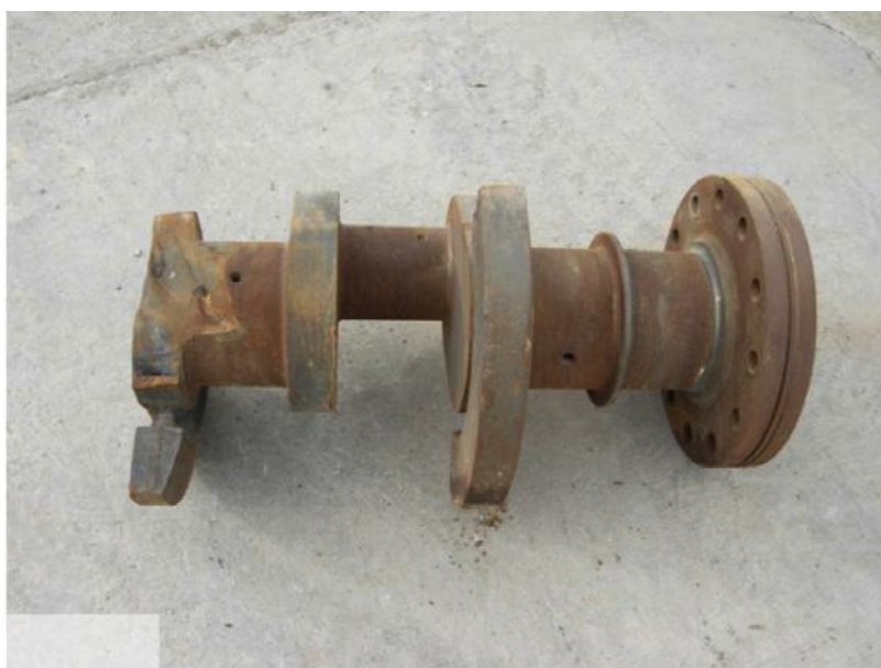
Σχ. 3.1.11 Σημείο θραύσης στροφαλοφόρου Νο 2
