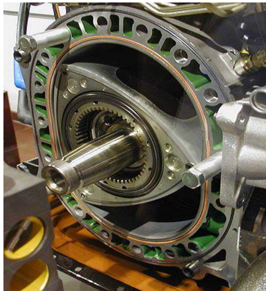
Σχ.1.4: Τομή κινητήρα Wankel
