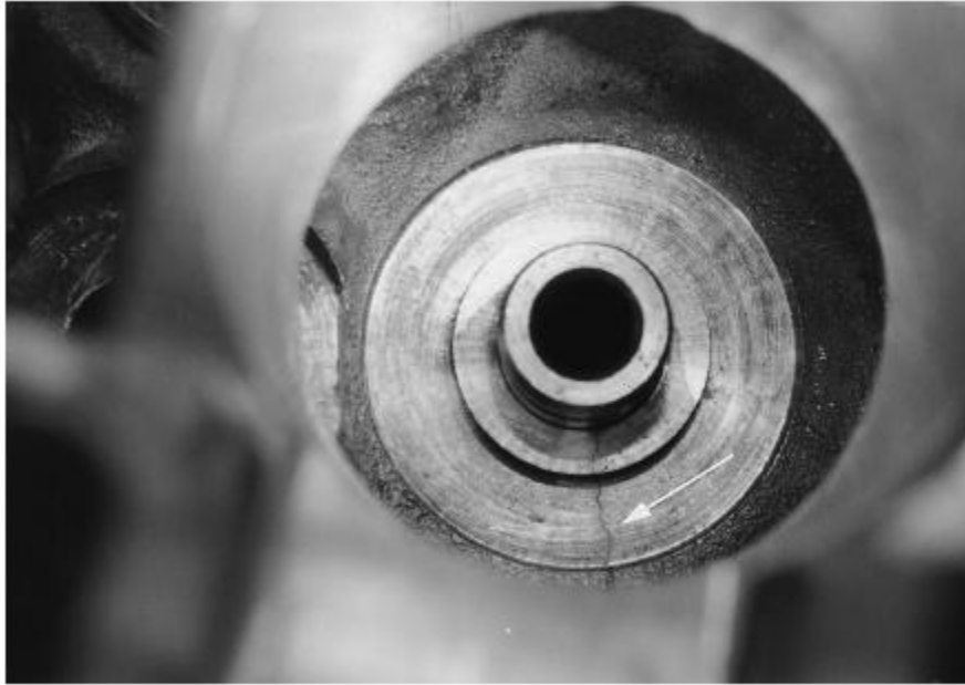
Σχ. 5.2: Ρωγμή οδηγού βαλβίδας επί της κεφαλής
