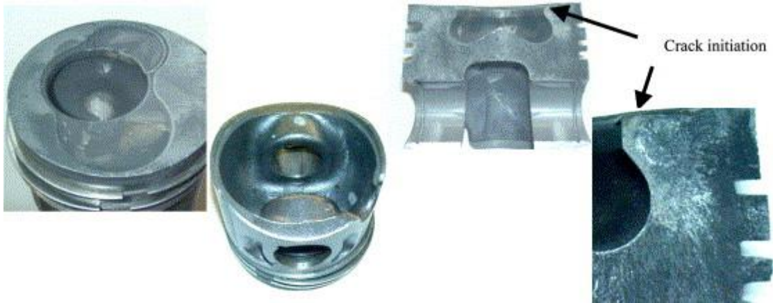
Σχ. 4.4: Έμβολο περελαιοκινητήρα με ρωγμή από την μια μεριά της οπής μέχρι την άλλη μέσω της ρωγμής στην κεφαλή του.
