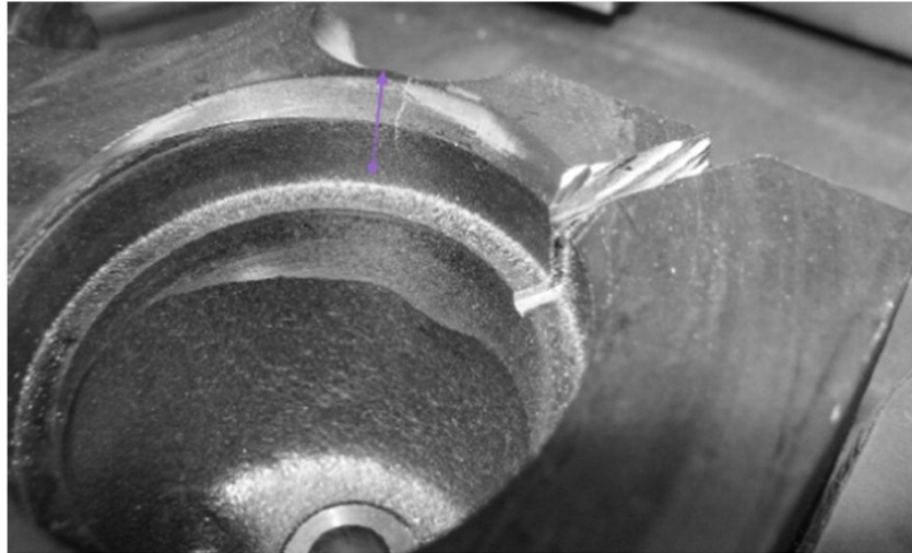
Σχ. 5.13: Ακτινική ρωγμή γύρω από την περιοχή της γέφυρας της βαλβίδας.
