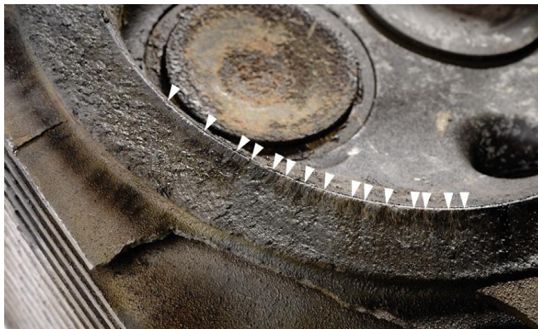
Σχ. 5.6: Προβολή τμήματος A της επιφάνειας θραύσης, που απεικονίζουν κάθετα σημάδια στην περιφέρεια της κεφαλής (ratchet marks).
