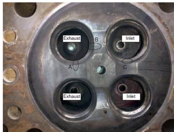
Σχ. 5.8: Περιοχές αστοχίας της επιφάνειας καύσης της κεφαλής.
