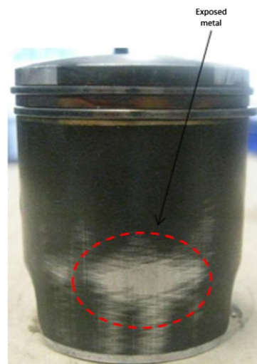
Σχ. 4.23: Έμβολο με επικάλυψη από μολυβδαίνιο που φέρει εκδορές στο κάτω μέρος.
