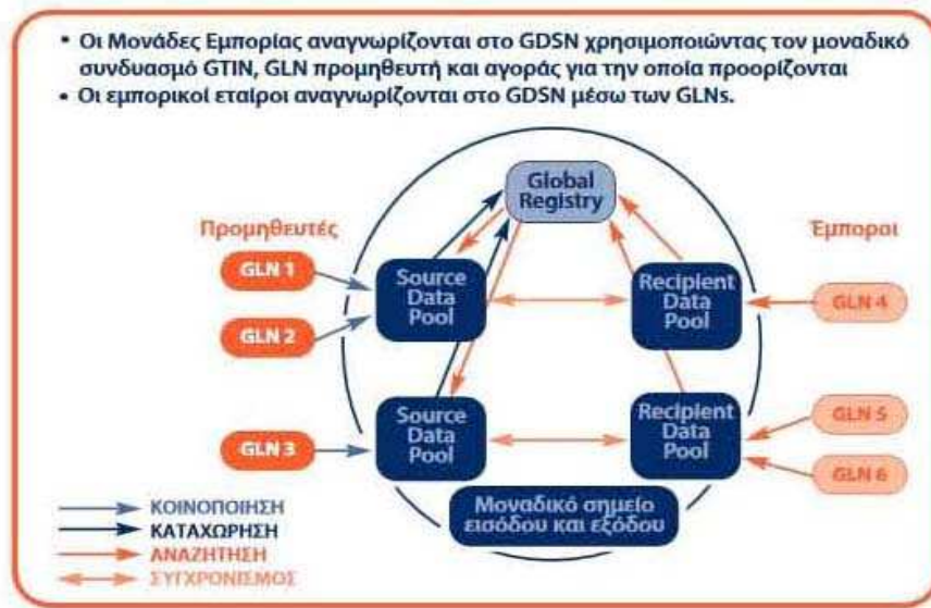
Σχήμα 3.3 Τυπική δομή συστήματος ιχνηλασιμότητας GS1 το οποίο δρα μέσω κωδικών μονάδων εμπορίας (Κυράνας, 2013).
