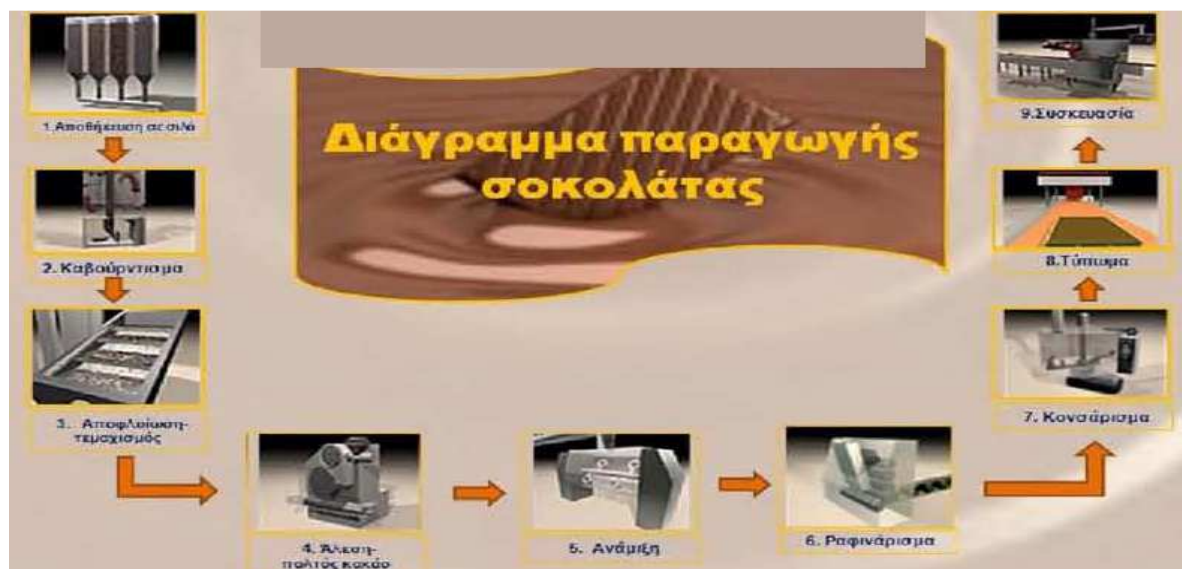
Σχήμα 2.5 Διάγραμμα ροής παραγωγικής διαδικασίας προϊόντων σοκολατοβιομηχανίας (Svahrudin, 2011).
