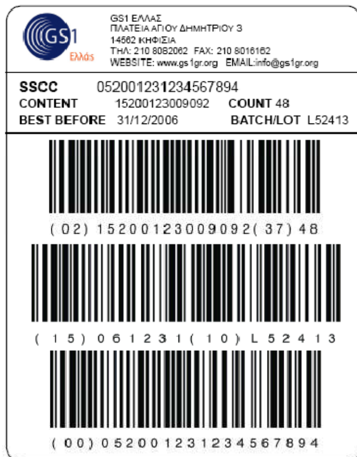
Σχήμα 3.4 Πρότυπο μορφοποίησης ετικέτας εφοδιαστικής αλυσίδας GS1 (GS1, Greece, 2016).
