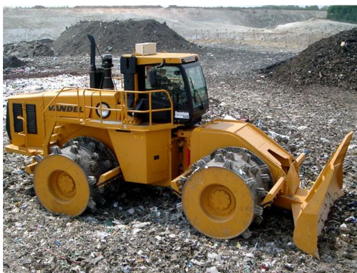
Εικόνα 3.22_Μηχάνημα Πρώθησης και Τεμαχισμού - Συμπίεσης (φέρει δόντια στους τροχούς) [52]
