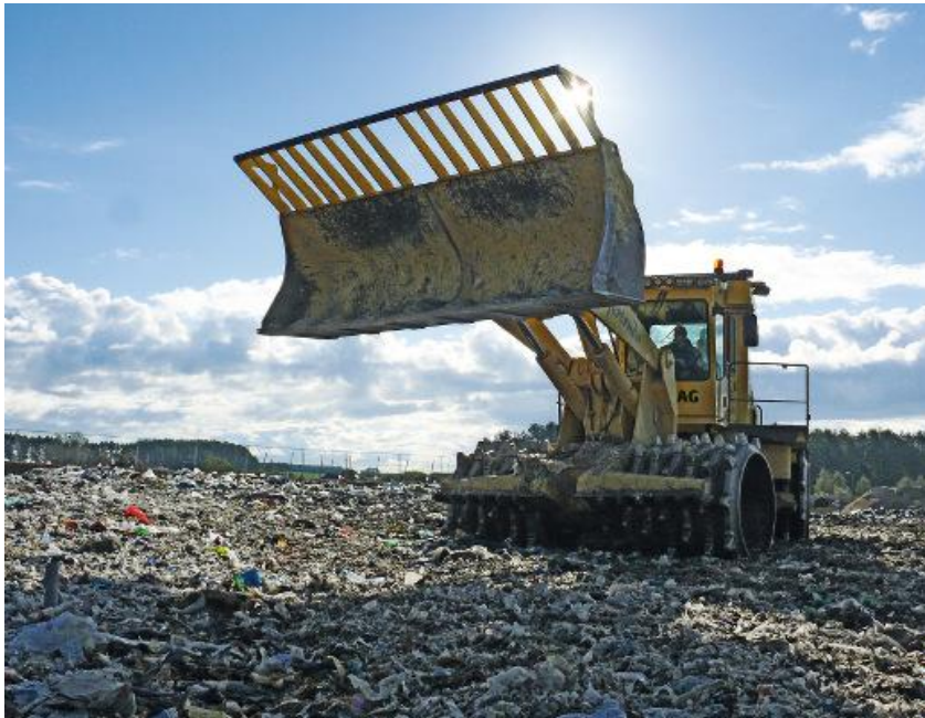
Εικόνα 47.8_Μηχάνημα Συμπίεσης και Προώθησης ΑΣΑ (φέρει δόντια στη θέση των τροχών) [52]
