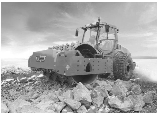
Εικόνα 3.9_Συμπιεστής που φέρει δόντια (κατάλληλος για διάστρωση μπαζών) [52]
